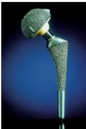
Abb. 7: Die aktuelle Spongiosa-II-Metall-Prothese ist mit einer reproduzierbaren Tripodenoberfläche teilstrukturiert und als modulares System mit einem Adapterkonus versehen.
